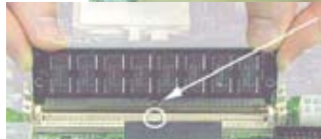
شکل ۴-۴ نحوه جا زدن حافظه از نوع SIMM از نوع SIMM بصورت مورب
