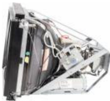
شکل ۶-۱۲ نمای داخلی صفحه نمایشی CRT از روبرو (سمت راست) و از بالا (سمت چپ)
