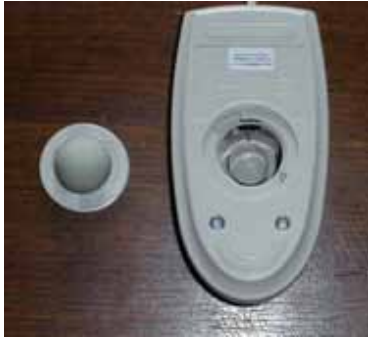
شکل ۶ - ۶ نمای زیر یک ماوس اپتومکانیک
